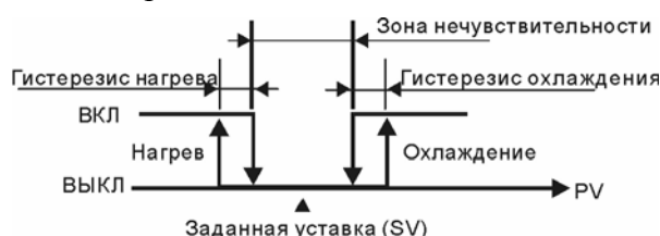
Рис. 1. Двухконтурное управление при релейном регулировании (ВКЛ/ВЫКЛ)
